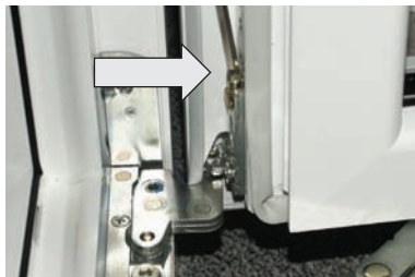
Anheben und Absenken des Flügels mit Inbusschlüssel SW4, bei Schwerlastbeschlag mit Torx T25.
