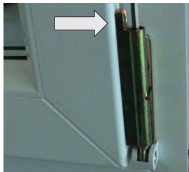
Anheben und Absenken des Flügels mit Inbusschlüssel SW4.
