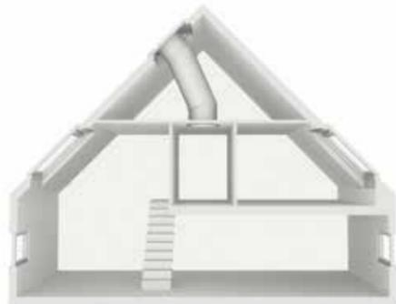
Tagsüber spart man Kunstlicht: der Lichteinfall wird über ein Rohr in den Raum darunter geleitet. Ergänzend ist ein LED Beleuchtungszusatz für die Abendstunden verfügbar.
